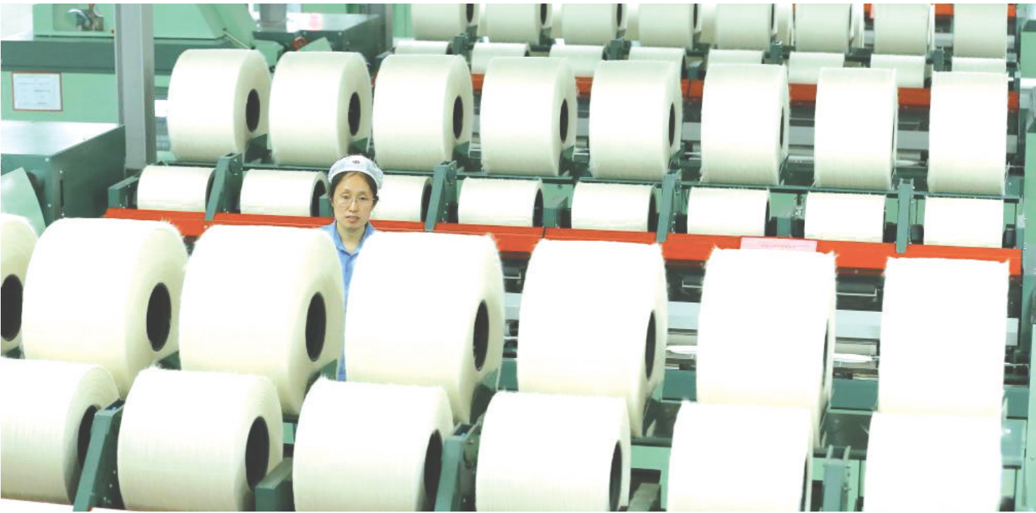
8月22日,青岛即发盛宝纺织有限公司工人在数字化纺纱智能生产线上生产高端纤维。近日,在山东省青岛市即墨区即发龙山工业园的青岛即发盛宝纺织有限公司,10万纱锭数字化纺纱智能工厂投产运转。据悉,该工厂全流程采用智能化纺纱成套装备,实现了运营智能化、装备智联化、制造数字化,可生产高端多功能纤维材料,用工由原来的1万锭50人降为10人以下。 新华社发(梁孝鹏 摄)
