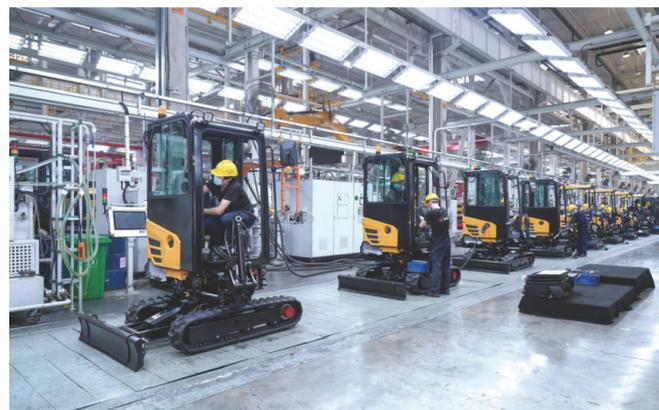
近日,在三一重机有限公司车间内,工人们正在一丝不苟地安装零部件,加紧赶制出口订单。三一重机有限公司以生产和销售挖掘机等工程机械产品为主,客户遍布全世界。
