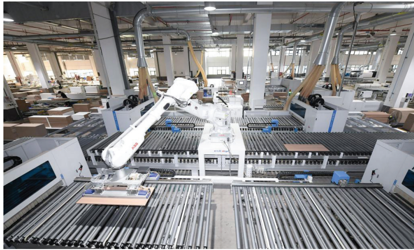
9月22日，在位于安吉县的乐捷家居股份有限公司，机械臂在智能家具钻孔工作站分放板材。
